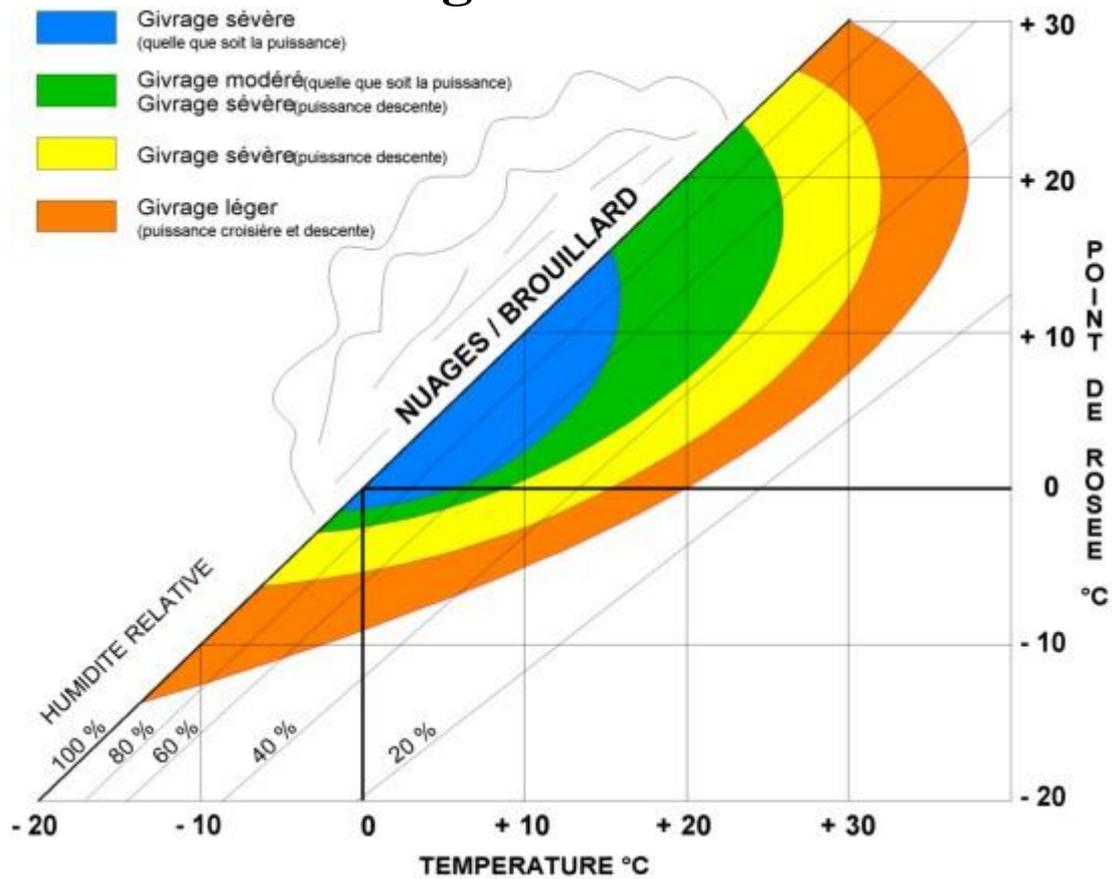
**Phénomène dangereux** ayant pour effet, de générer de la glace à l'intérieur du carburateur empêchant l'arrivée du carburant et de provoquer l'arrêt du moteur
